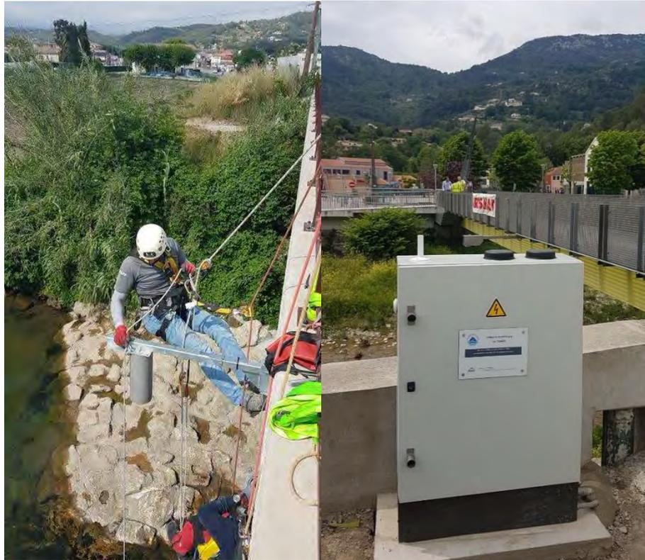
Le SMIAGE a acquis un **ADCP** (Acoustic Doppler Current Profileur), c'est à dire un **profileur courantmètre acoustique à effet Doppler**.
