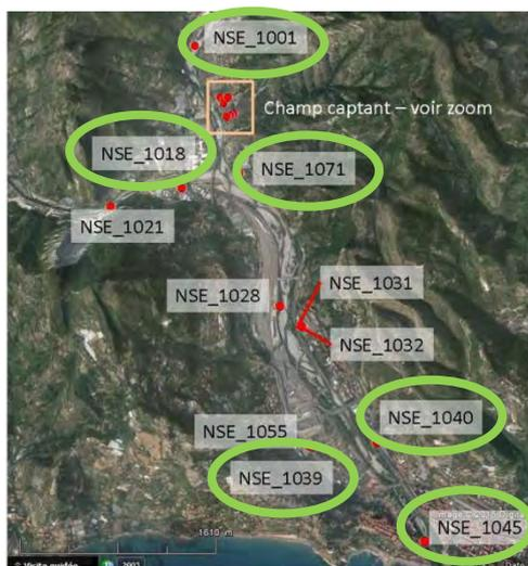
Pour rappel, le SMIAGE a instauré un suivi piézométrique de la nappe dès 2015 (6 sondes de mesures).
