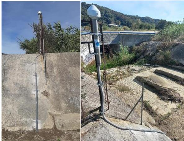
*Figure 3 - Sonde piézométrique installée sur le vallon de l'Enghieri à Gattières*
