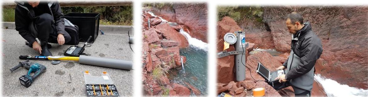
La sonde a été placée dans le Cians, en aval de la commune de Beuil, proche de la route. Après une mise en place difficile (arrachée à 2 reprises par les crues et bugs du matériel informatique dus au froid), le SMIAGE a pu obtenir une chronique complète de données sur les années 2019 à 2023 (cf. graphiques suivants).
