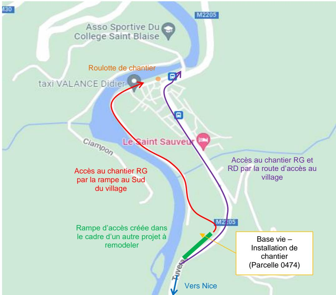
**Figure 2-6 : Installation de chantier et accès de chantier disponibles pendant toute la durée des travaux**
